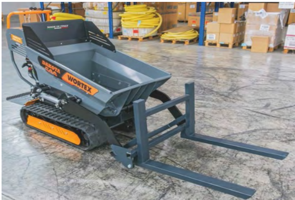
Figura 16. Carretilla con motor de oruga y transpaleta. Posible medio de transporte terrestre en la zona de arena hasta el paseo marítimo
